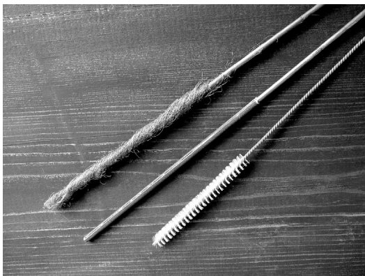
Obr. 10: Pomůcky na čištění vývrtu píšťaly – válcový kartáč, trn s brusným papírem a trn s brusnou kovovou vlnou
