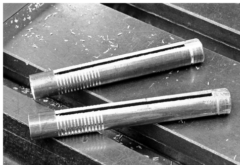
Obr. 6: Hotové trubičky – po vyfrézování dosedací plošky pro plátek
